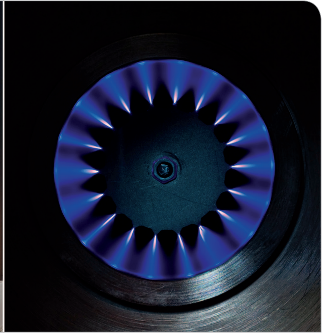
Prototyp des Carola-Rußabscheiders, Corona-Entladung.
