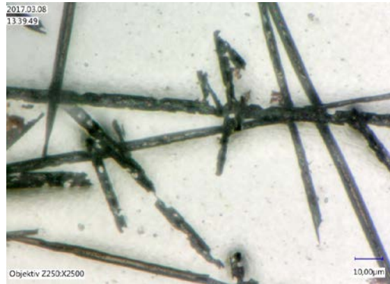
Lichtmikroskopische Aufnahme einer durch thermische Belastung deutlich angegriffenen CF-Probe (Foto: KIT).
