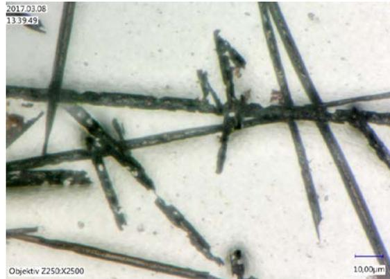
Lichtmikroskopische Aufnahme einer durch thermische Belastung deutlich angegriffenen CF-Probe (Foto: KIT).
