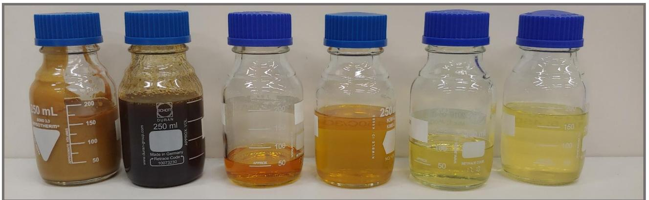
*Flüssiges Produkt der katalytischen Pyrolyse von Polyolefinen.*
