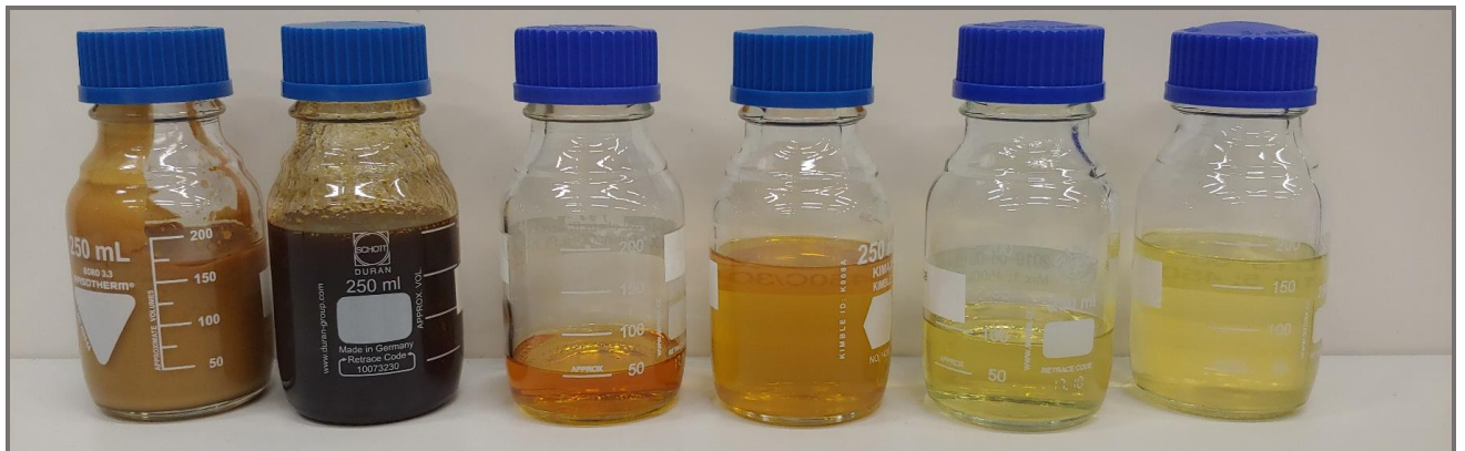
Flüssiges Produkt der katalytischen Pyrolyse von Polyolefinen.
