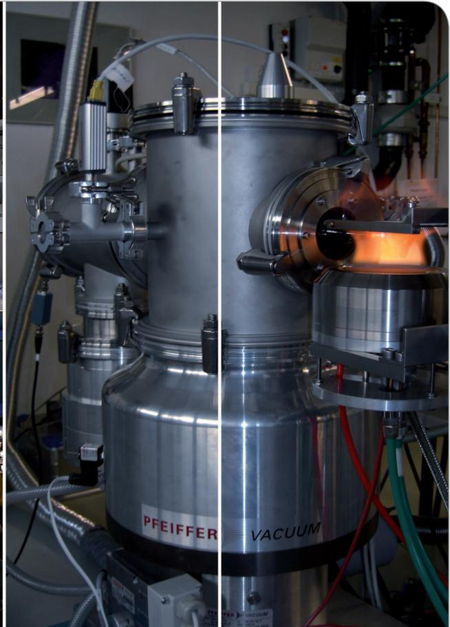
Partikelmassenspektrometer für die Rußmessung in einer atmosphärischen Flamme.
