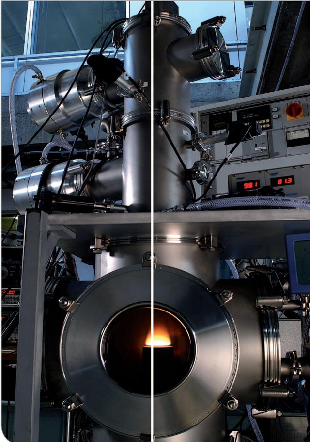
Partikelmassenspektrometer für die Rußmessung in einer Niederdruckflamme.
