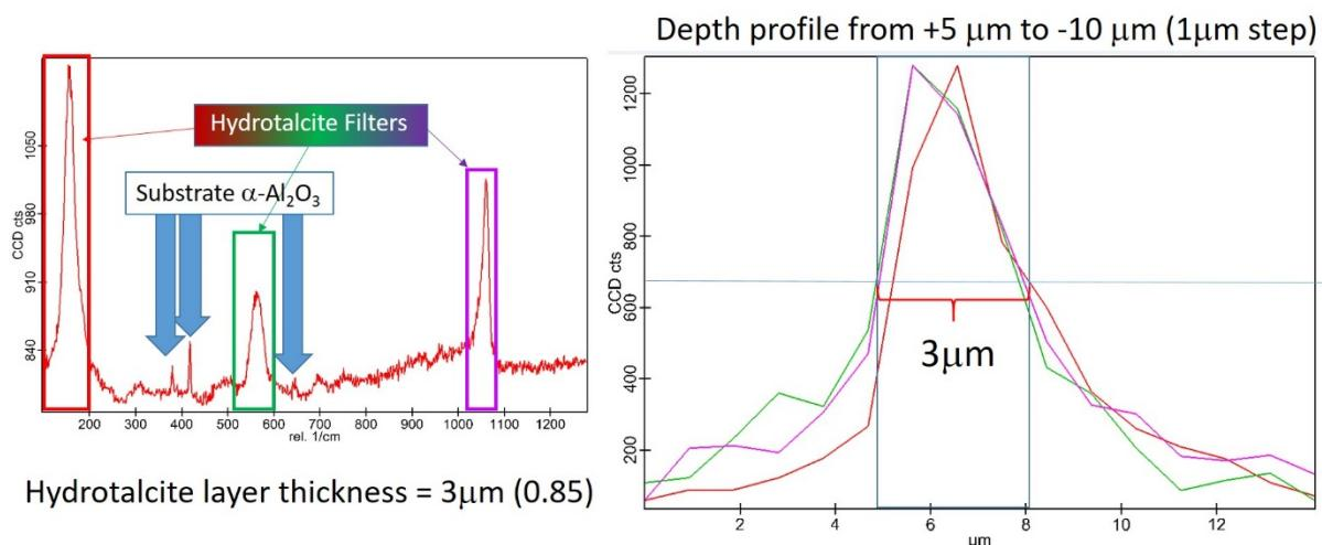
*Bestimmung der Dicke einer Hydrotalcit-Schicht auf einem  $\alpha\text{-Al}_2\text{O}_3$  Substrat mittels Raman Tiefenprofilen*
