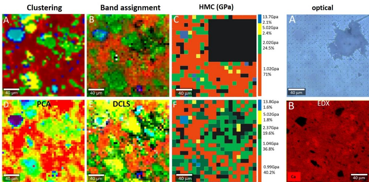
Vergleich zwischen verschiedenen Auswertungsmethoden (Clustering, PCA, spezifische Peaks, DCLS etc.) von Hyperspektralen Datensätzen und entsprechenden mechanischen Eigenschaften ermittelt mit Nanoindentation (C, F). Rechts: Optisches Bild und Ca-Verteilung (EDX)
