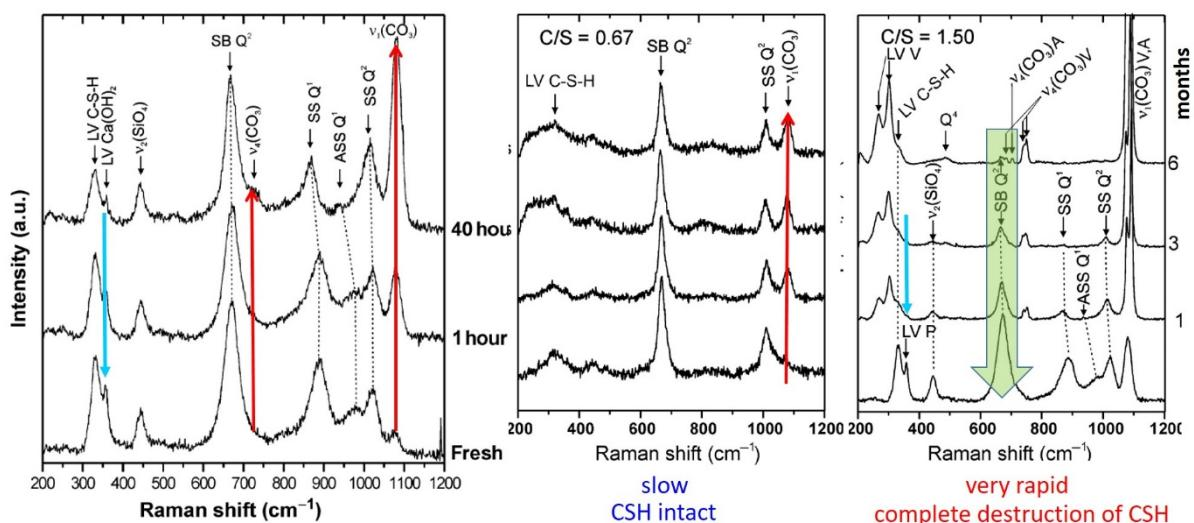
Carbonatisierung von CSH Phasen in Abhängigkeit von Ca/Si Verhältnis
