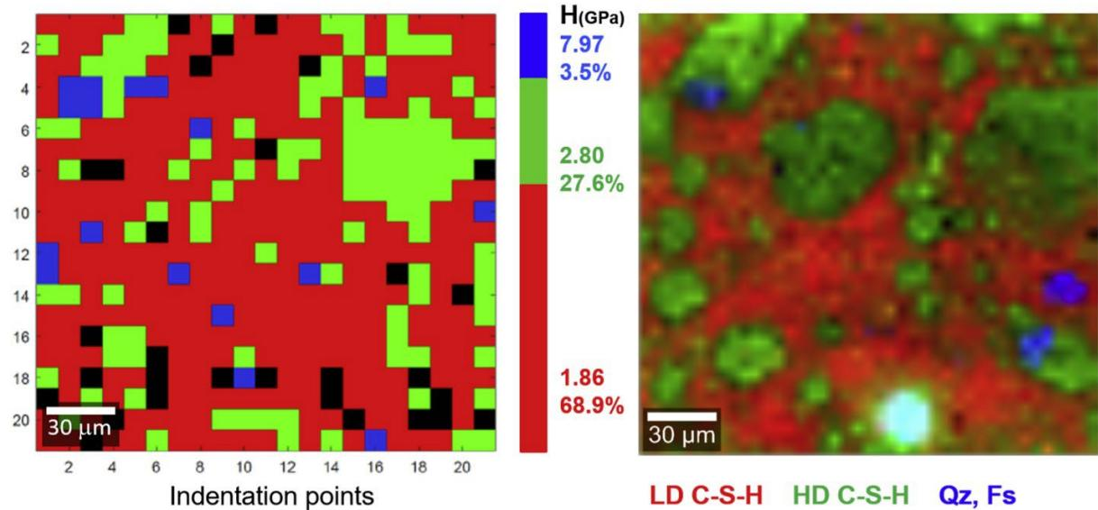
Vergleich zwischen der Verteilung von mechanischen Eigenschaften (Härte) (Links) und der entsprechenden Phasenverteilung ermittelt mit Raman Imaging.
