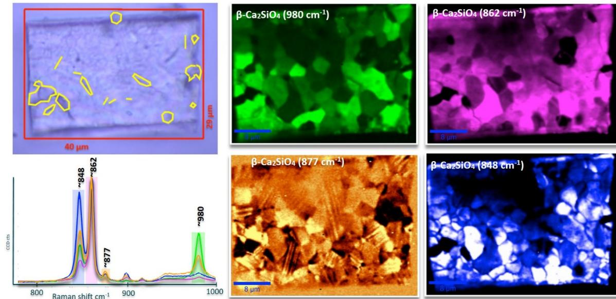
Abbildung unterschiedlicher Domäne und Verzwilligung in beta  $\text{Ca}_2\text{SiO}_4$
